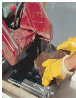
Příklad řezání cihel mokrým řezem
