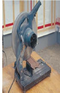
Příklad řezání cihel suchým řezem
